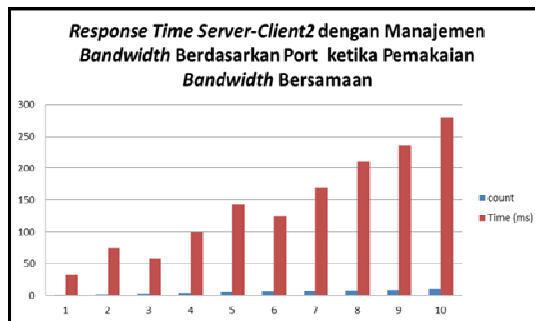
Gambar 11. Response Time Server-Client2 dengan Manajemen Bandwidth Berdasarkan Port ketika Pemakaian Bandwidth Bersamaan
