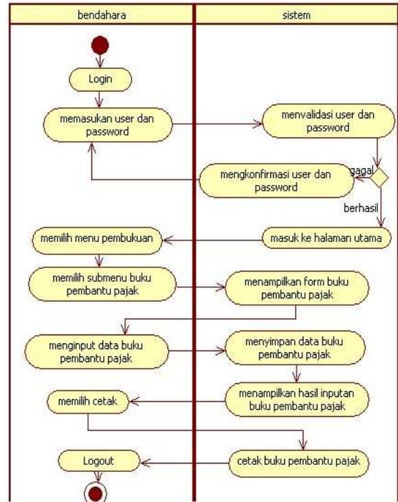
Gambar 6. Activity Diagram Pengolahan Data Buku Pembantu Pajak
