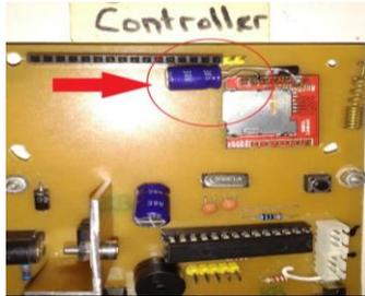
Gambar 14. Penambahan capacitor pada supply tegangan SIM8001
