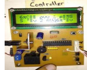
Gambar 12. *display LCD error*.
