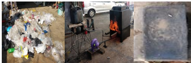
Gambar 8. Plastik-Proses Pemanasan-Paving Block
